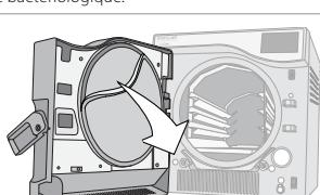
Replacer le joint d'étanchéité de la porte.
