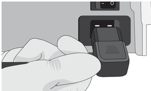
2. Spojite izravno na izvor napajanja. Ne upotrebljavajte produžni kabel.
